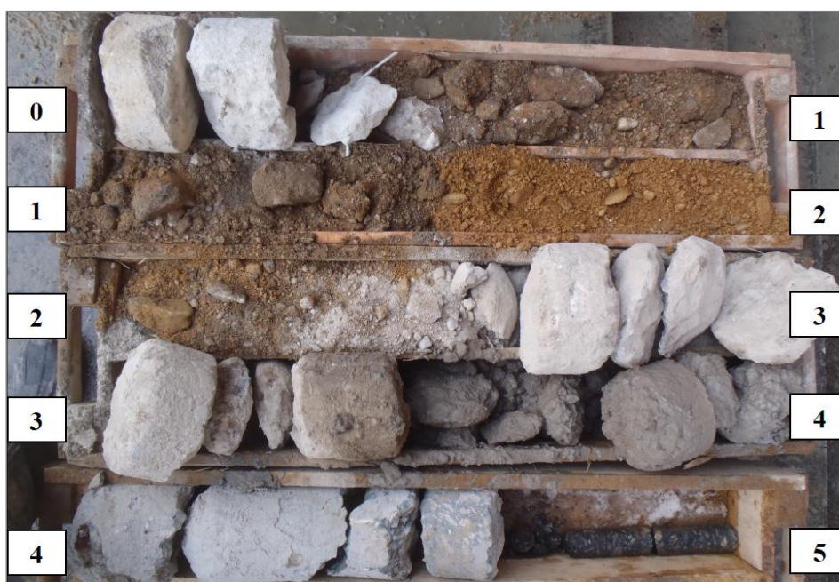
Obr. 8 – Polohy písčitých navážek a betonu zastiženého ve vrtu V1. Fig. 8 Layers of sandy fills and concrete encountered in borehole V1.
