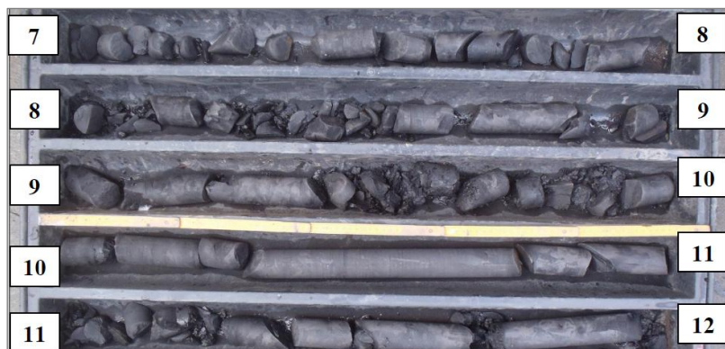
Obr. 7 Slabě až silně rozpukané břidlice libeňského souvrství ve vrtu V10. Fig. 7 Slightly to intensely fractured shales of the Libeň Formation in borehole V10.
