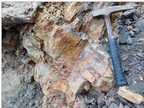
Obr. 13 Detail tektonické plochy s výrazným ohlazem a rýhováním v řevnických křemencích.
