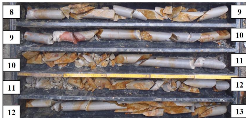
Obr. 6 Polohy křemenců s různou intenzitou rozpukání zastížené ve vrtu V9. Fig. 6 Quartzite layers with varying degrees of fracturing encountered in borehole V9.
